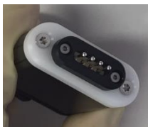
Contact probe Spacing : 3 mm
